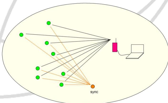
En option, un modem spécifique de synchronisation Ondisync® permet de déclencher par radio, depuis un point quelconque du site, une mesure simultanée sur l'ensemble des modems:
